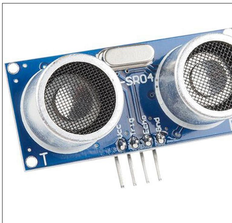
trasuoni a 40 kHz e l'altro per ricevere l'eco prodotto dall'ostacolo detto anche target. In quest'articolo mi soffermerò più sul principio di funzionamento che sul sensore, il cui utilizzo è molto semplice con microcalcolatori che misurano la durata di un impulso.
