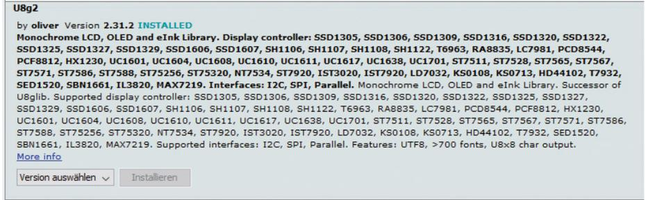
Figura 5: Selezionare la libreria U8g2 per pilotare il display OLED da 1,3."
