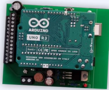
Figura 3b: Arduino Uno montato a faccia in giù sulla motherboard.
