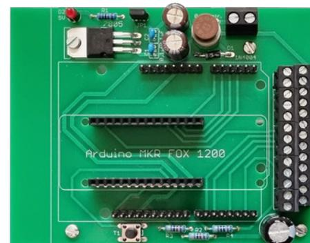
Figura 2: Il PCB della motherboard del semaforo CO<sub>2</sub> finito.
