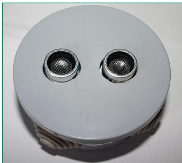
L'HC-SR04 all'interno del contenitore
